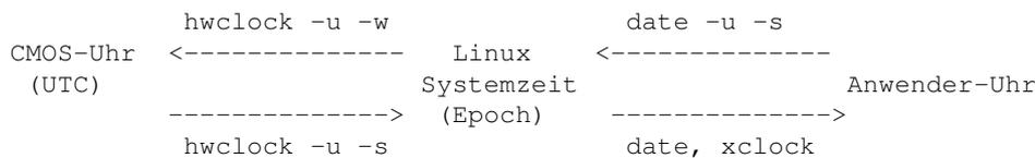
Zwar liest der Kernel schon beim Booten die CMOS-Uhr aus und interpretiert sie als UTC. Aber um systematische Fehler der CMOS-Uhr zu korrigieren, wird die Uhrzeit von einem der Systemstart-Skripte im Verzeichnis `/etc/init.d/` ein weiteres Mal gelesen. Übernimmt man die Linux-Systemzeit mit dem Kommando `netdate` von einem Zeit-Server, dann muss man die CMOS-Uhr mit dem Kommando `hwclock` nachziehen.
